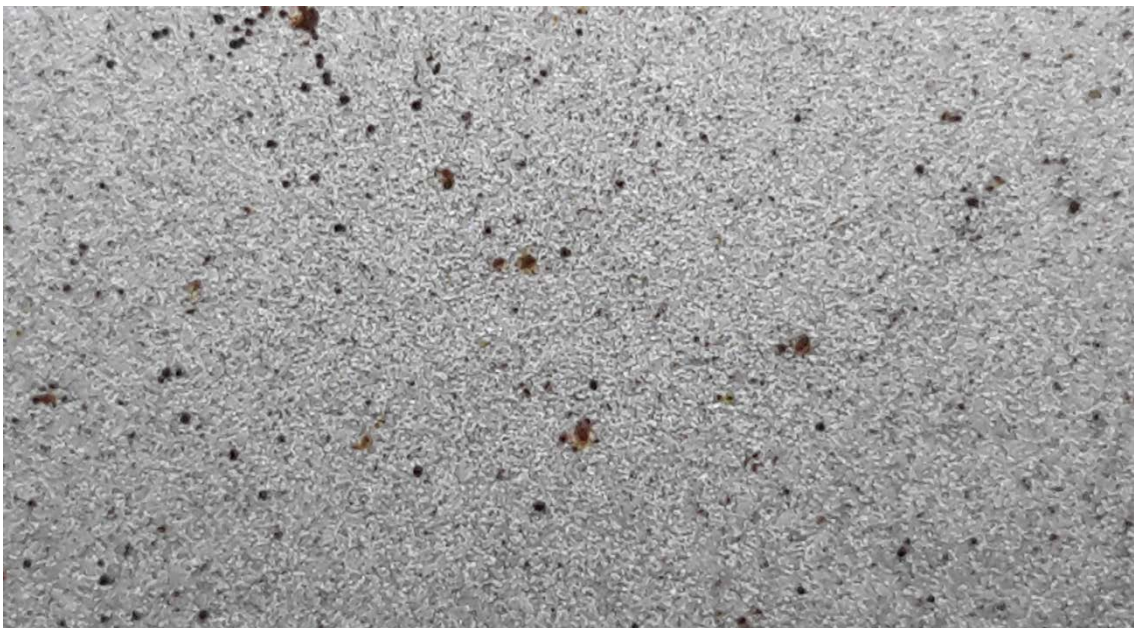
Foto 3. Aantasting van lak en roestvorming op een van de beschadigde auto's
